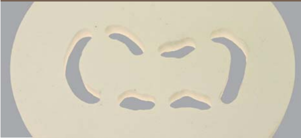
Cortar el interior con fresa de tungsteno
