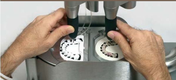
Colocar bloque de zirconia y fresar
